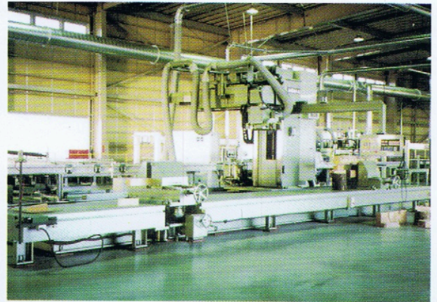
■梁丸太加工機 HH-8000-7NC型
